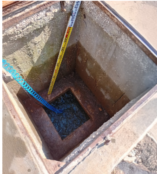
תמונה 5 | דוגמה לבדיקת עומד פיאזומטרי וספיקות באיחוז על ידי סגירה זמנית עם פקקים פנאומטיים, עין חומה, באדיבות חברת ריינסורס
