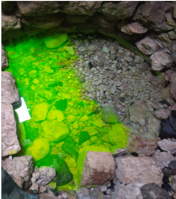
תמונה 6 | דוגמה לבדיקת קישוריות וספיקות תת-קרקעית במערכת מים מנדטורית בעזרת צבען, עין חוקוק, באדיבות חברת ריינסורס
